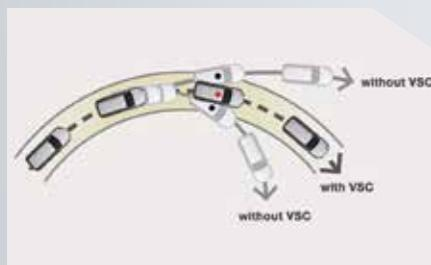
**Hệ thống cân bằng điện tử VSC với công tắc tắt OFF**
